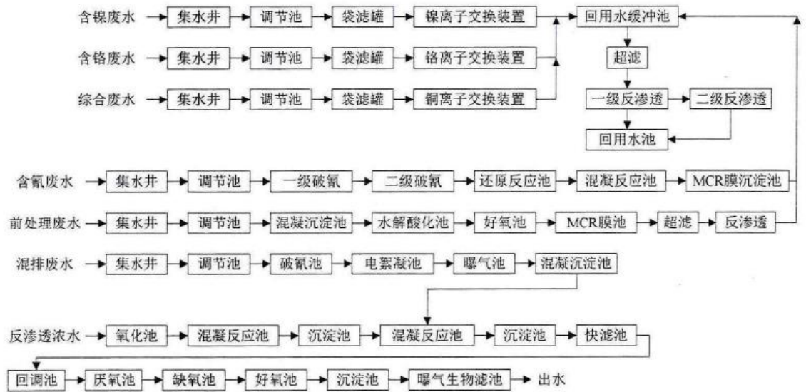
图 3-21 龙溪电镀基地现废水处理工艺
