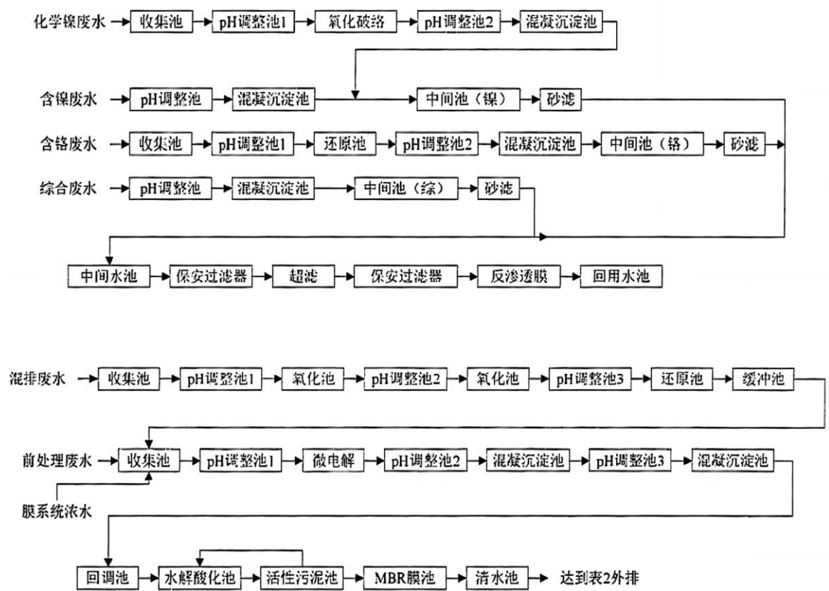
图 3-22 如东开元表面处理中心电镀废水处理工艺流程图
