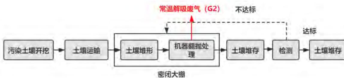
图 3-8 VOCs 污染土壤常温解吸修复工艺流程图
